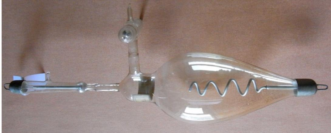
Montée en série dans le circuit d'alimentation du tube a Rx . La soupape est destinée a bloquer l'onde inverse afin de ne pas détruire le tube Rx (fonctionnement dans l'autre sens )
